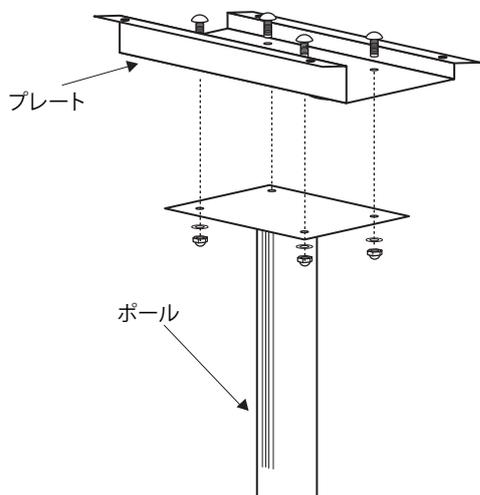
2]次に、【1】で接続したプレート付きポールをポストに設置して下さい。
