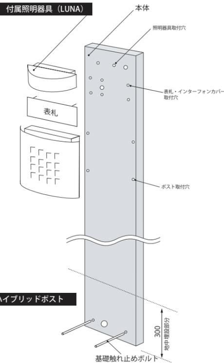
※取付器具の照射面は、必ず下向きして設置してください。上向き、横向きの設置は故障や事故の原因になりますので絶対にお止めください。
