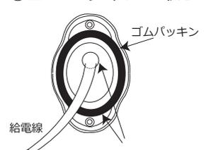
ゴムパッキンが本体の裏面に接する部分と給電口周辺にシリコンコーキング(太線部分)を施して下さい
