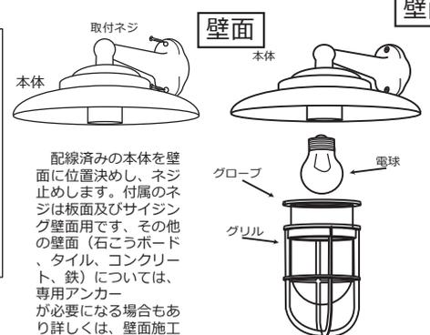
配線済みの本体を壁面に位置決めし、ネジ止めします。付属のネジは板面及びサイジング壁面用です。その他の壁面(石膏ボード、タイル、コンクリート、鉄)については、専用アンカーが必要になる場合もあり詳しくは、壁面施工業者様にお問い合わせください。
