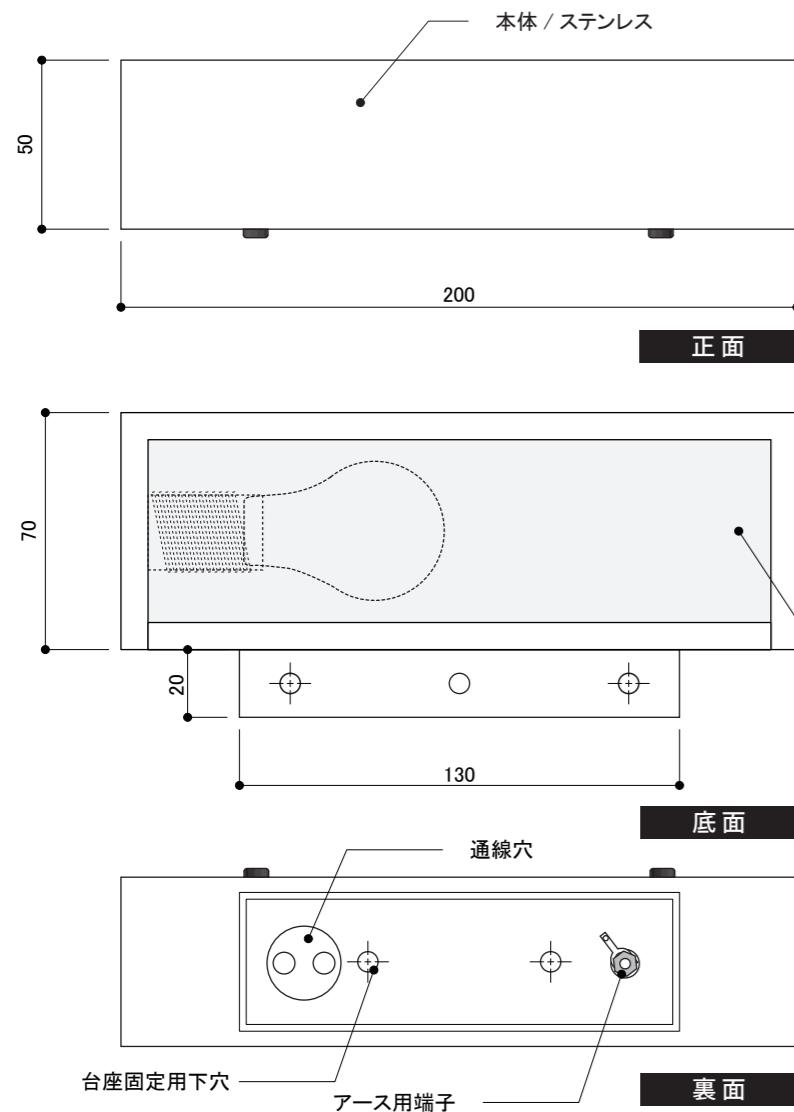
※取付器具の照射面は、必ず下向きして設置してください。
