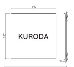
市販のタイル用接着剤で圧着固定。 表から接着剤がすけて見えますので、 団粒状ではなく全面均一に塗布して下さい。
