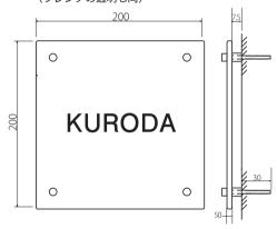
穴の位置は、グラス穴より直接鉛筆などで、印をつけて下さい。 適合ドリル穴 6mm~6.5
